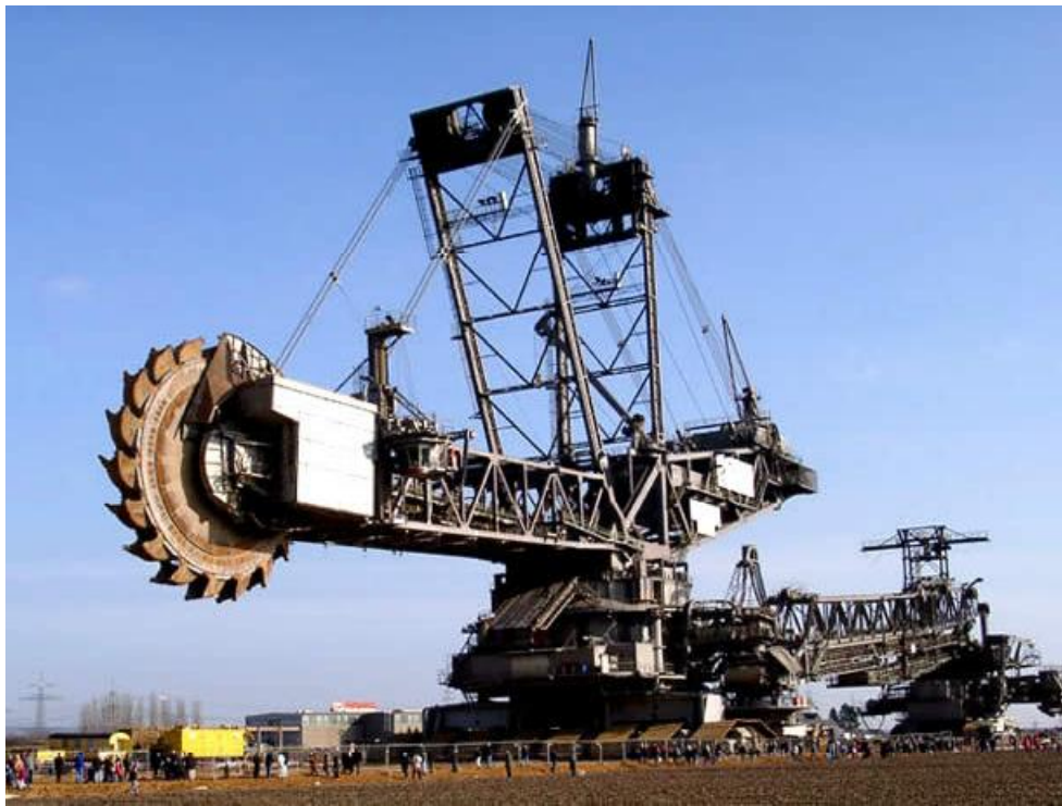
Obr. 1.1.19: Kolesový ryhovač (korčekový) extrémnych rozmerov
