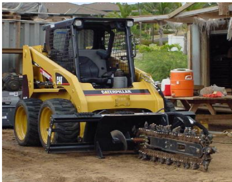
Obr. 1.1.22: Prídavné zariadenie ryhovač na šmykom riadenom nakladači firmy Caterpillar
