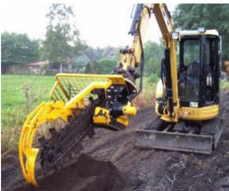
Obr. 1.1.25: Prídavné zariadenie ryhovač k minirýpadlu
